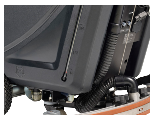
Indicador de nivel de agua con volumen visible en el depósito
