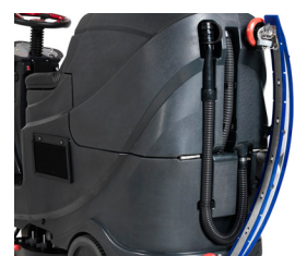
Soporte en la parte trasera para colgar la boquilla y poder pasar por zonas estrechas
