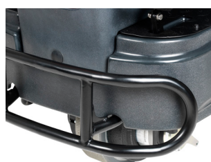
El parachoques delantero estándar protege la máquina para una vida útil más larga
