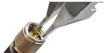
El cortante micro-mini 7292MI se utiliza para cortar un cable de conexión a tierra dentro de un miniconector.
