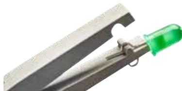
Los alicates para moldeado RX 601 dejan un espacio en el cable y en los cables LED.
