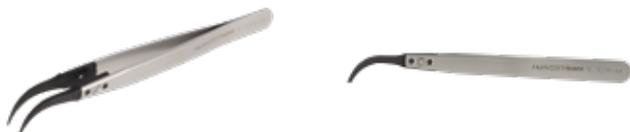
Las pinzas de plástico de punta reemplazable tipo 7CF son adecuadas para aplicaciones que requieren sujetar firmemente un componente pequeño. La geometría curvada proporciona la máxima visibilidad y una mayor ergonomía. El plástico ESD reforzado con fibra de carbono proporciona a las pinzas propiedades ESD y antirayaduras.
