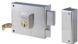
Variante: Cerradura de sobreponer de un punto de cierre 125 con palanca y picaporte, cilindro redondo de 25mm de diámetro 70mm longitud, entrada de 50mm, caja de 100mm, mano derecha, acabado hierro niquelado.
