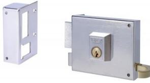
Variante: Cerradura de sobreponer de un punto de cierre 125 con palanca y picaporte, cilindro redondo de 25mm de diámetro longitud 70mm, entrada de 60mm, caja de 120mm, mano izquierda, acabado hierro niquelado.
